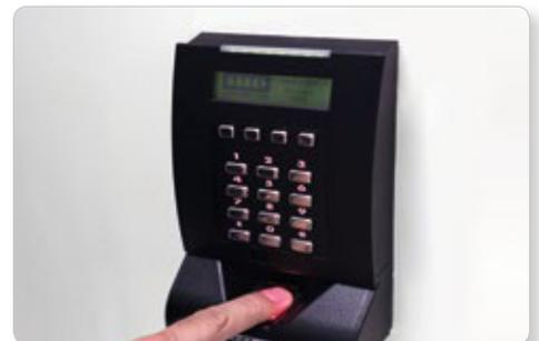
Accesso tramite lettore di dati biometrici
